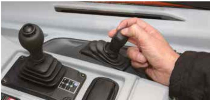
**Levier de commande de la benne**
