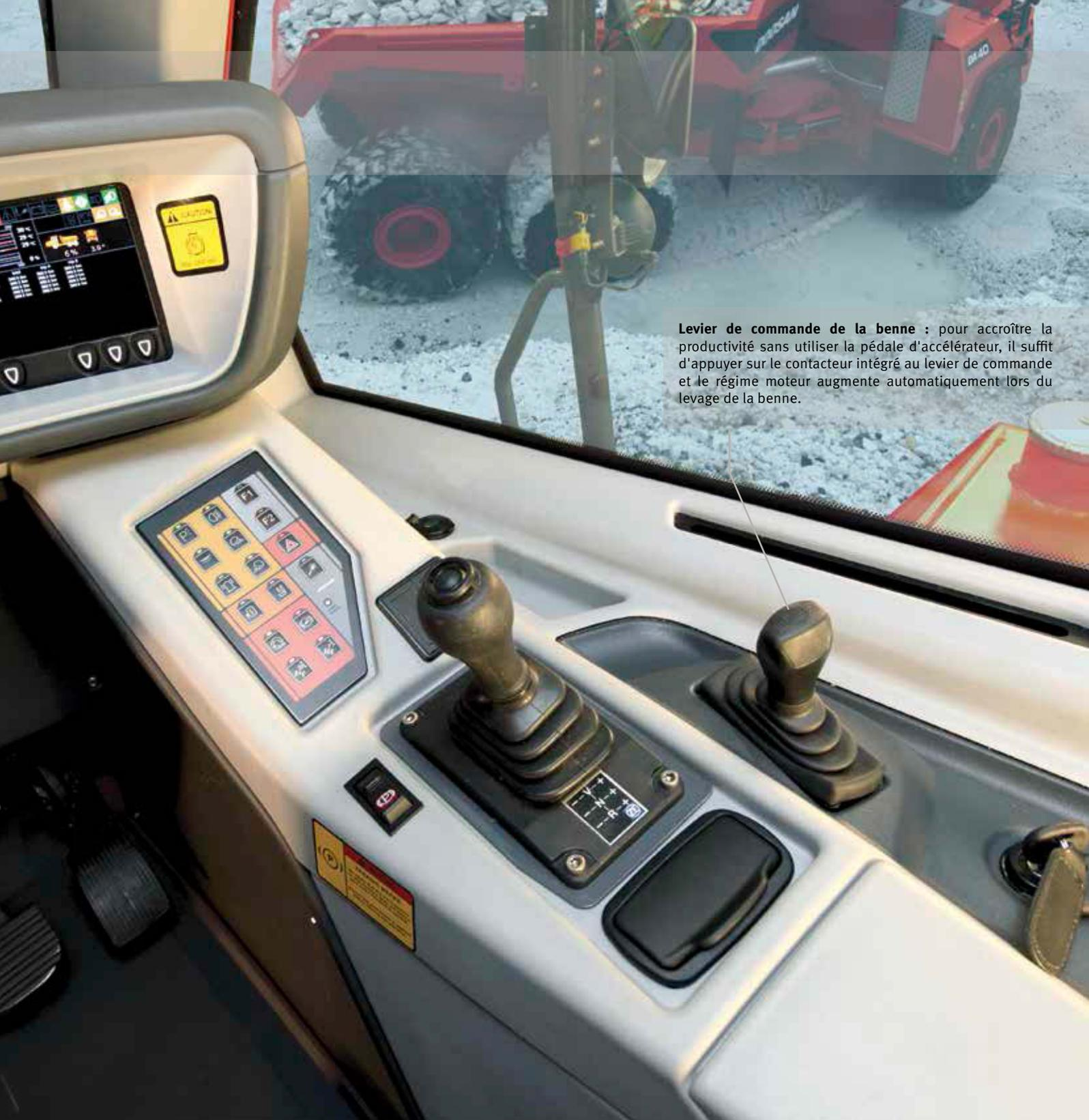
**Levier de commande de la benne :** pour accroître la productivité sans utiliser la pédale d'accélérateur, il suffit d'appuyer sur le contacteur intégré au levier de commande et le régime moteur augmente automatiquement lors du levage de la benne.
