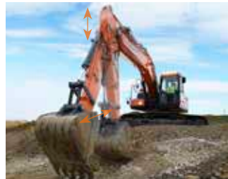
Fonction de flottement de la flèche
