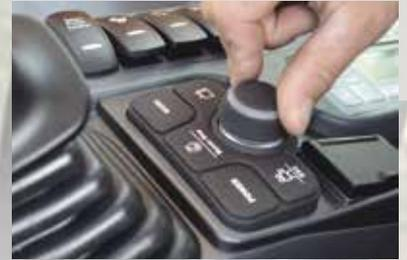
1. Contacteur de surpression (Power Boost) et contacteur de décélération des accessoires hydrauliques
