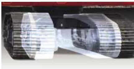
**Châssis inférieurs disponibles** : Châssis inférieur DX340LC-5 étroit / standard : 3,00 / 3,28 m avec tuiles de 600 mm.
