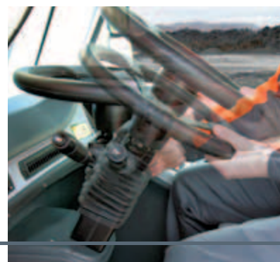
Colonne de direction réglable en inclinaison et en hauteur
